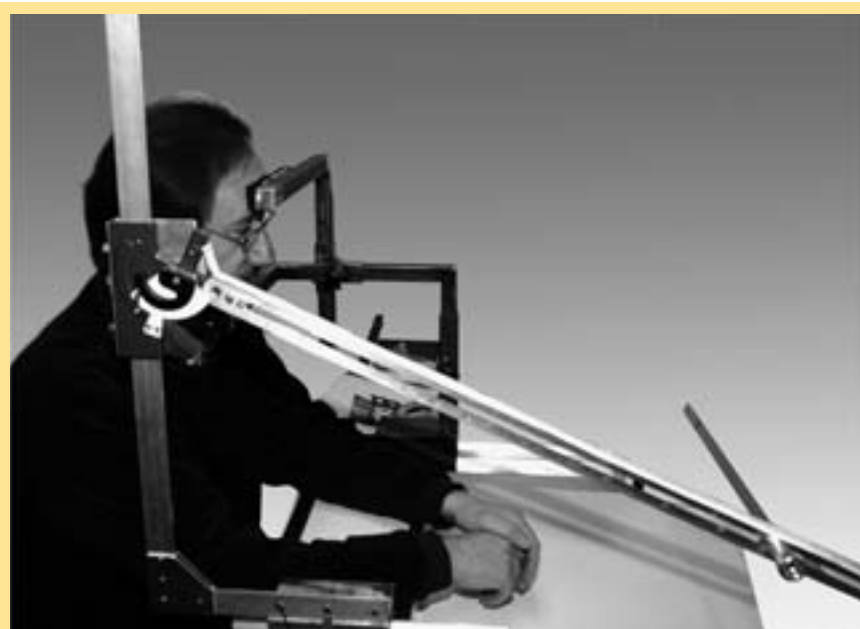
Abbildung 2: Laborapparatur (Eigenkonstruktion) zur Messung des Akkommodationsnahpunktes als Funktion der vertikalen Augenneigung: Auf einer Schiene kann das Sehobjekt an beliebige Positionen geschoben werden. Die Schiene lässt sich vertikal um eine Achse schwenken, die der vertikalen Augendrehachse entspricht. Die Kopfstütze wird so eingerichtet, dass der Proband seine individuell komfortable Kopfhaltung einnimmt.
